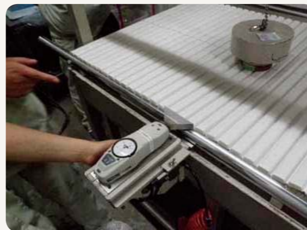
ふたの上面に手をついた途端、ふたが滑って人が浴槽内に落下することを防止
