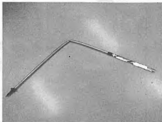
屈伏状態での破壊例
