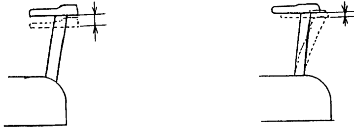
図6. サドル部及びサドルポストの耐荷重試験 永久変形の測定
